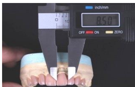
Figura 13. Obtenção da medida de largura no modelo encerado com paquímetro calibrado, exemplo da obtenção das medidas dos dentes.
