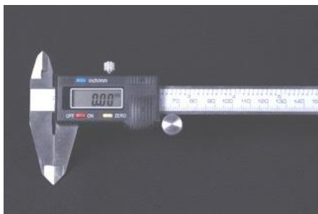
Figura 4. Paquímetro digital (Leetools, Marbeg, China).
